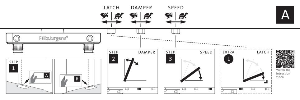
**SPEED** DAMPER LATCH FritsJurgens® STEP DAMPER STEP SPEED **EXTRA** LATCH STEP Watch the intruction video  $\mathbb{L}$
